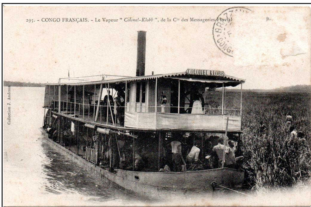
Le vapeur « Colonel Klobb » armé par la Compagnie générale de Transport en Afrique est un petit bateau à roue construit en 1900 (ou 1908). 25 tjb, 24 tpl, 25,90 x 4,30 x 0,80 m, 125 ch, 7 nœuds. Dépecé en 1955. Intégré à partir du 6 août 1914 dans une flottille chargée de conduire des opérations militaires dans la région du moyen-fleuve Congo et placé sous les ordres de l'enseigne de vaisseau Jean Théophile Charles Ducrocq ; précédemment affecté à la mission hydrographique du Congo.
